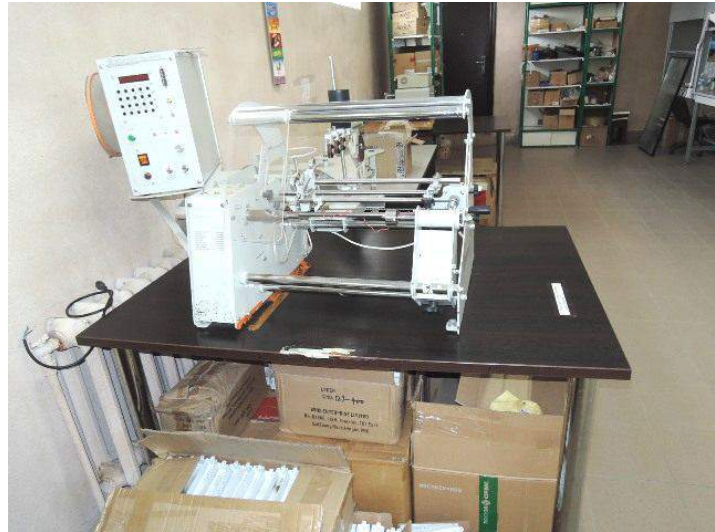
Установка струйной отмывки (ECO) ОКО 2000MP IMO
